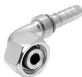
Kolena 90°, lehká řada s vnitřním závitem DIN 24°, s o-kroužkem, otočné
