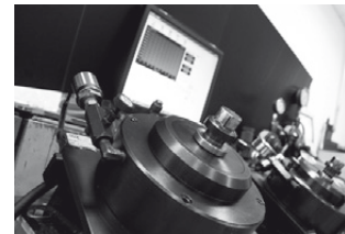
Test kroutícího momentu utahováku
